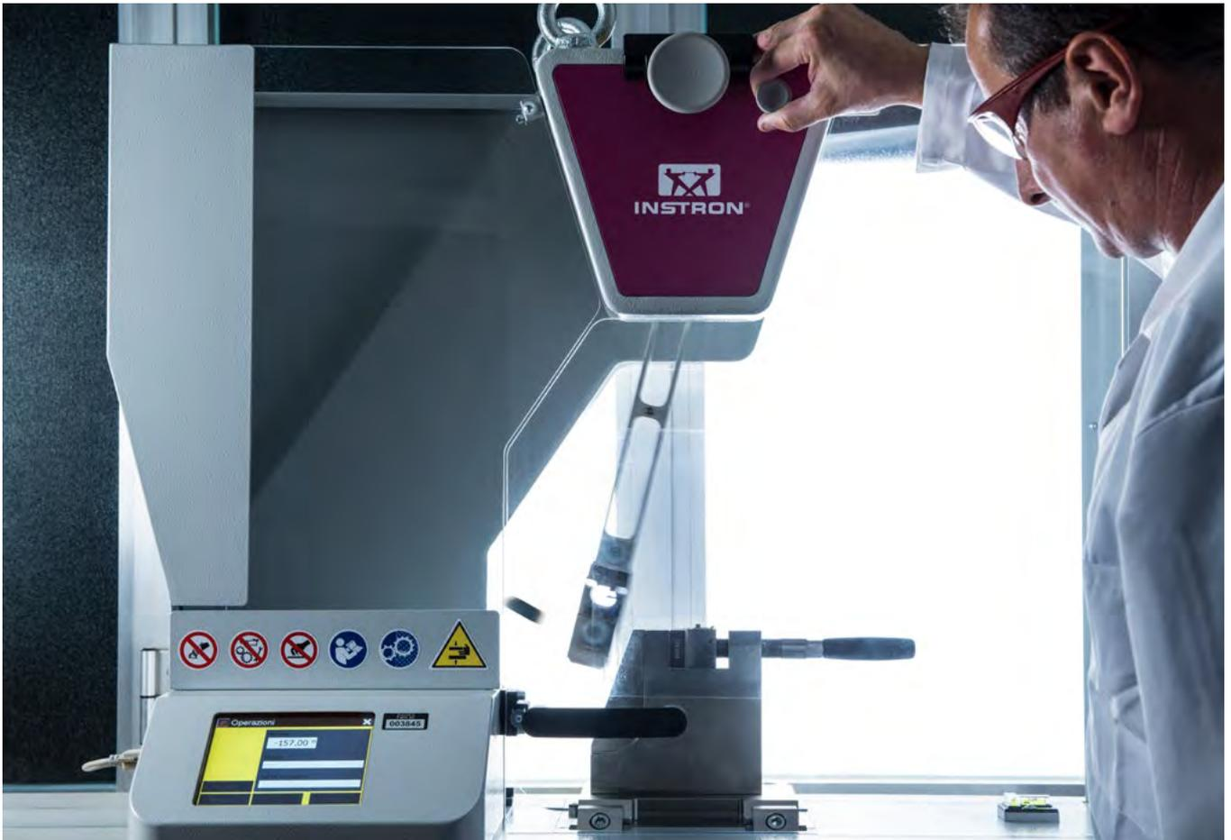
Test d'impact par mouton-pendule.
