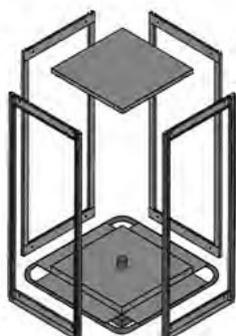
Le rayonnage pivotant Practibox est constitué de une base pivotante à 360° sur laquelle sont fixés 4 châssis pour blocs-tiroirs Practibox, disponibles en 3 hauteurs différentes.
